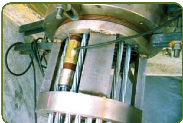
Fig. 3.3 – Célula de carga para medida de forças nas cordoalhas – ancoragem
