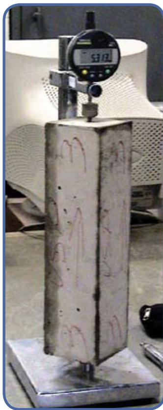
Figura 5 – Medição dos Prismas pelo Método CPT
