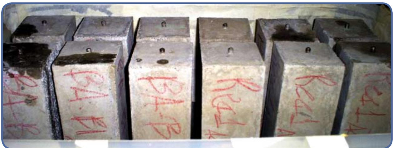
Figura 4 – Recipiente de Armazenamento do Método CPT
