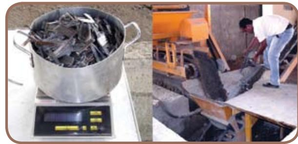
**Foto 5** – pesagem e adição de fibras ao concreto destinado à produção dos tubos
