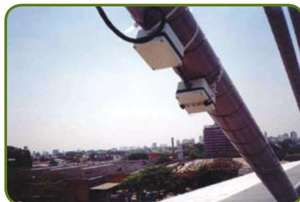
Fig. 4.2 – Acelerômetros nos estais da ponte sobre o Rio Pinheiros, LEM-EPUSP
