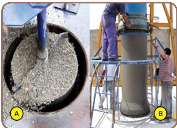
**Foto 4** – Detalhe da moldagem e desforma de um dos tubos utilizados no experimento
