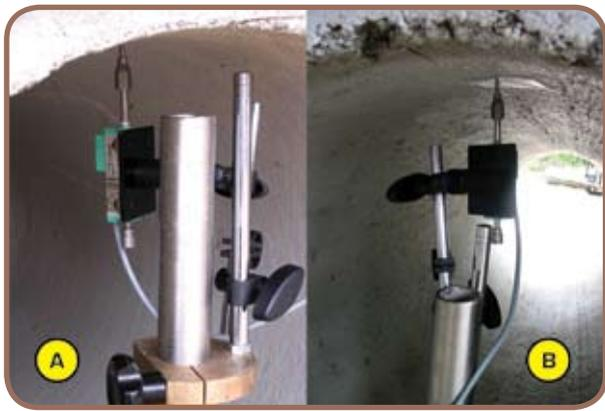
**Foto 3** – (A) detalhe do suporte para posicionamento do LVDT para leitura da deformação do tubo de concreto durante o ensaio de compressão diametral e (B) da folha de acetato que evitava a entrada da agulha em uma possível fissura
