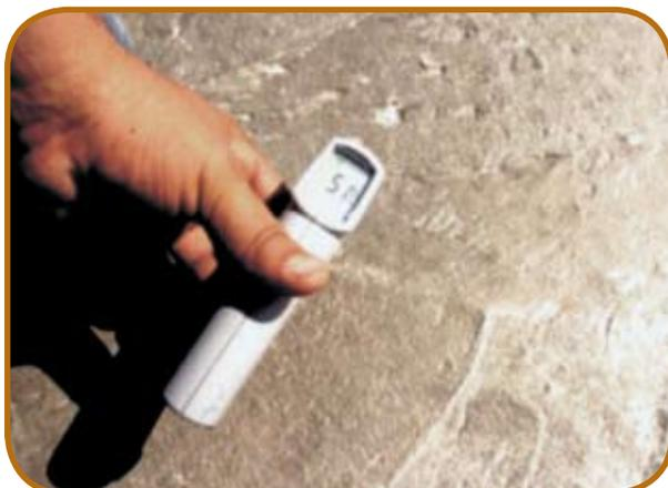
**Foto 6** – Determinação da temperatura da superfície exposta ao sol do concreto endurecido com 24 horas de idade, indicando 51°C. Uso de aparelho portátil para medida da temperatura através da irradiação infravermelha
