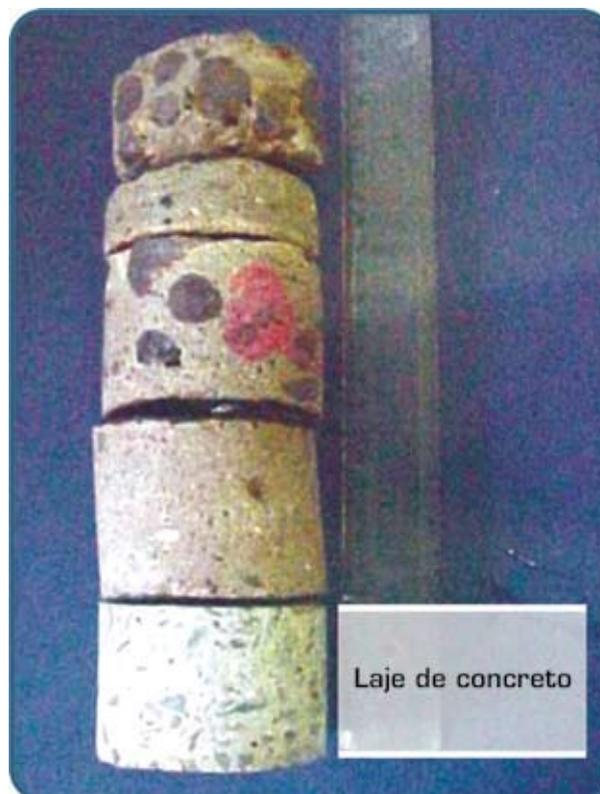
Figura 8 – Exemplo de camadas de sistemas de impermeabilização sobrepostas sobre laje de marquise
