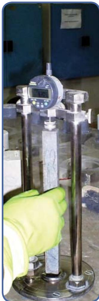
Figura 2 – Medição de Expansão das Barras de Argamassa (AMBT) com a utilização do relógio comparador.
