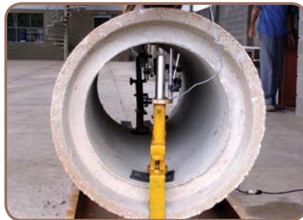
Foto 2 – configuração inicial do sistema de posicionamento dos LVDTs para medida contínua de deformação dos tubos de concreto
