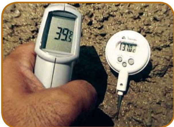
Fotos 2 e 3 – Detalhes de alguns tipos de aparelhos portáteis para a determinação da umidade relativa do ar, temperatura interna e da superfície do concreto
