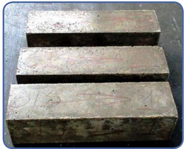
Figura 3 – Prismas de Concreto utilizados no método CPT
