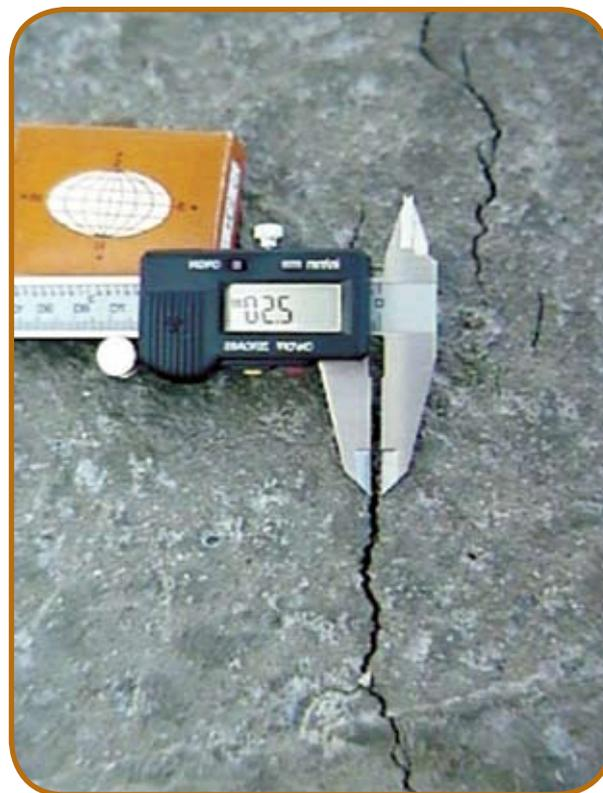
Foto 4 – Detalhe da abertura de fissura (2,5 mm) ocorrida em superfície do concreto ainda no estado fresco, devido à retração plástica por ação climática
