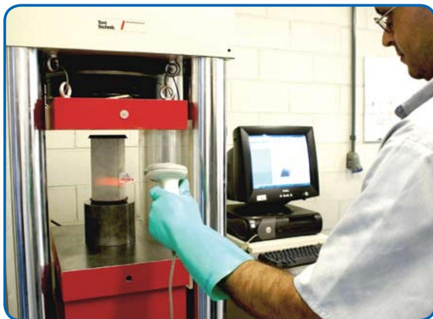
Rompimento do corpo-de-prova, os dados são transmitidos da prensa para o computador.
