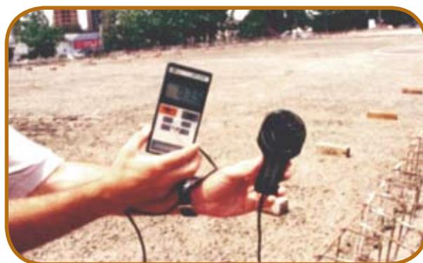
Foto 1 – Detalhe do aparelho portátil de medida da velocidade do vento (anemômetro)
