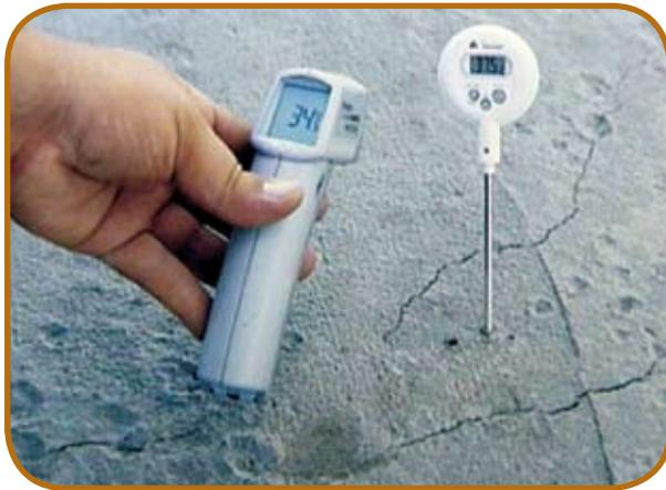
**Foto 5** – Exemplo da extensão e proximidade das fissuras na superfície do concreto em estado fresco, oriundas da evaporação da água de constituição
