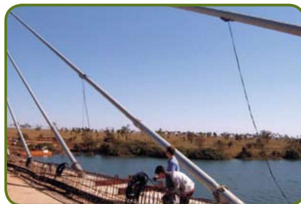
Fig. 3.4 – Vibrações do estai, pPonte Paranaíba, instrumentação com acelerômetros, LSE
