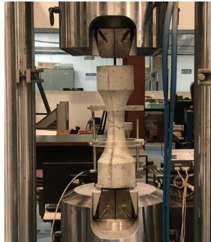
Figura 4 – Configuração Adotada para os Ensaios de Tração Direta.
