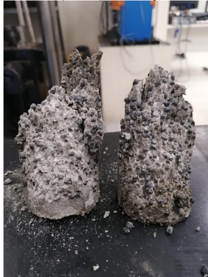
Figura 2 – Corpo de prova traço PP rompido
