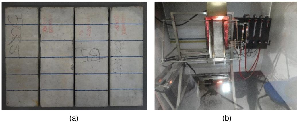
Figura 3 – Determinação do índice de propagação superficial de chama (a) amostras (b) aparato de ensaio
