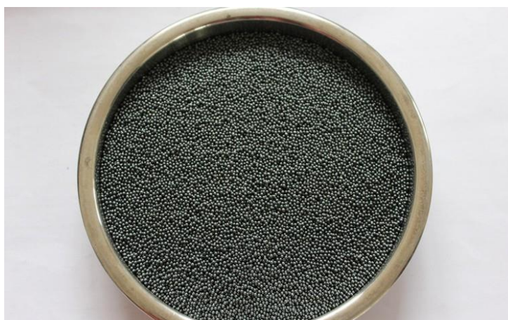
Figura 1 – Granalha de Aço
