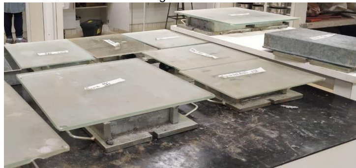
Figura 5 – Corpos de Provas Prismáticos para cada tipo de argamassa
