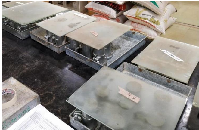
Figura 3 – Corpos de Provas Cilíndrico para cada tipo de argamassa
