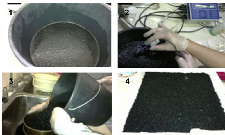
Figura 4 – Etapas do processo de tratamento da borracha com NaOH (YOUSSF et al. (2014))
