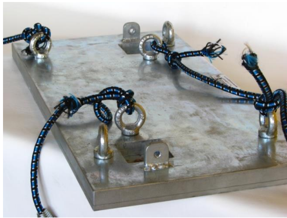
Figura 3 – Foto do Gabarito com cordas de fixação
