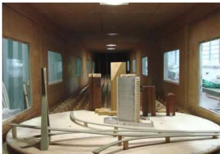
Fotografias do modelo do Empreendimento CENU Torre IV no interior do túnel de vento.
