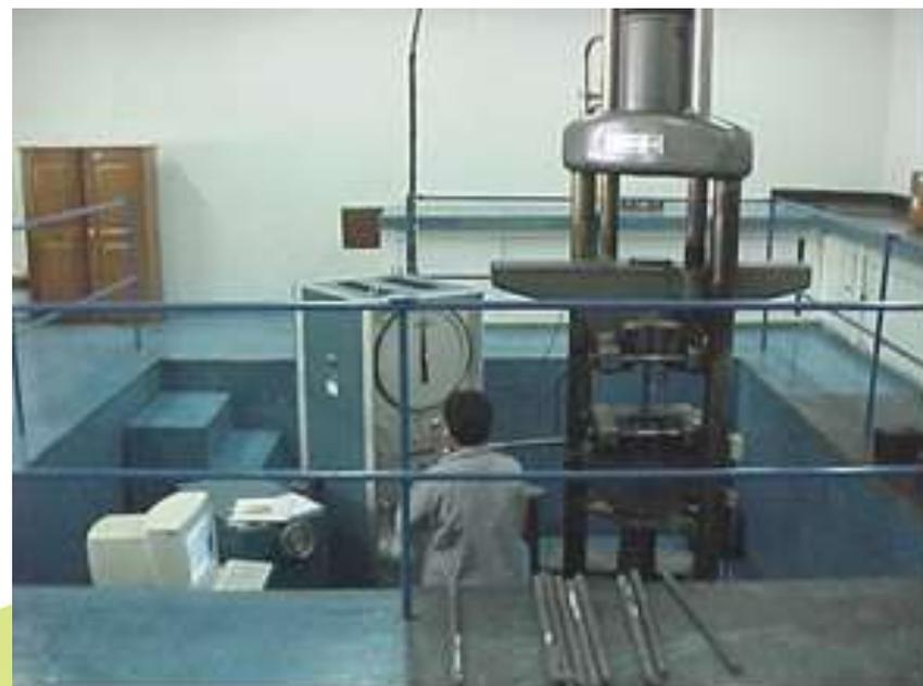
Sala Elasto-mecânica do Laboratório Central, podendo ser vista a prensa universal de 100 tf, durante o ensaio de tração em aço.
