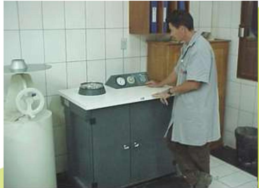
Sala Física do Laboratório Central, onde podem ser vistos o **peneirador aero-dinâmico** e a “**flow table**”.
