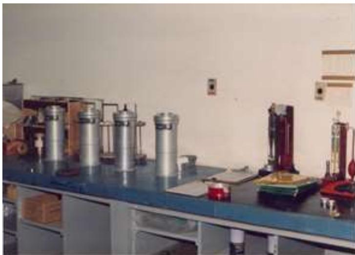
Garrafas de Langavant e permeabilímetros de Blaine, para as determinações de calor de hidratação e superfície específica do cimento.
