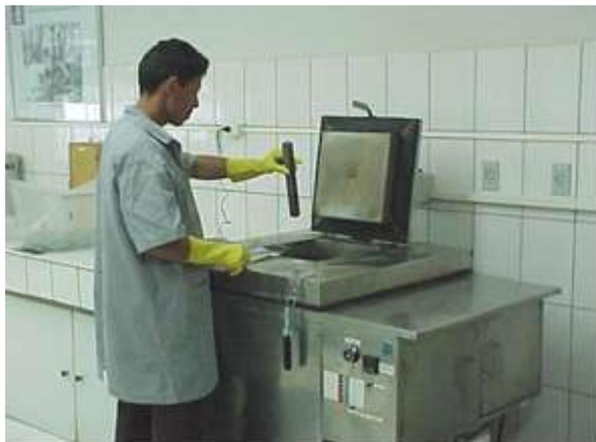
Sala Física do Laboratório Central, mostrando o calorímetro durante o ensaio de reatividade potencial do agregado, pelo método físico.
