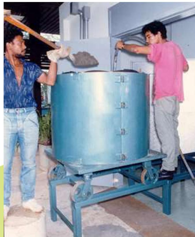
Moldagem do corpo de prova, para o ensaio de **elevação adiabática**.
