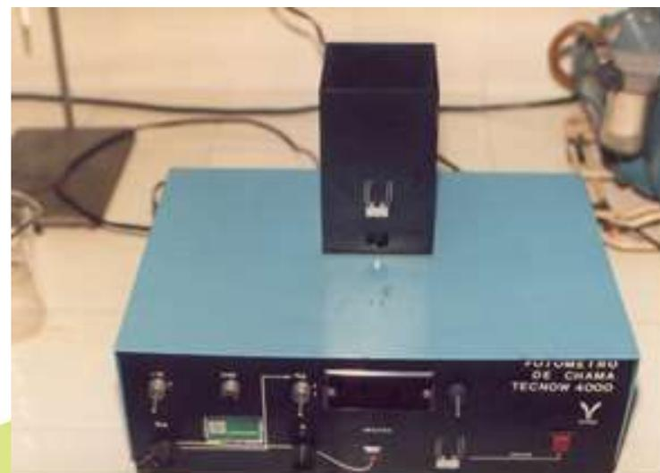
Fotômetro de chama, utilizado para a determinação dos álcalis do cimento.
