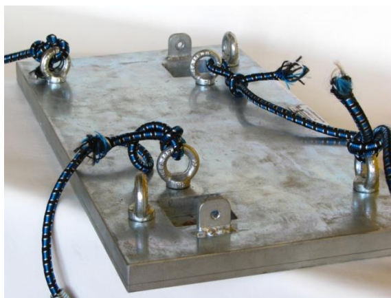
Figura 3 – Foto do Gabarito com cordas de fixação
