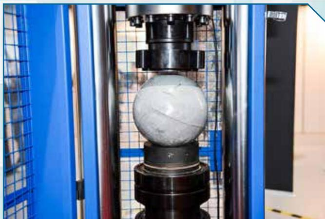
Bola é posicionada para ensaio de resistência à compressão
