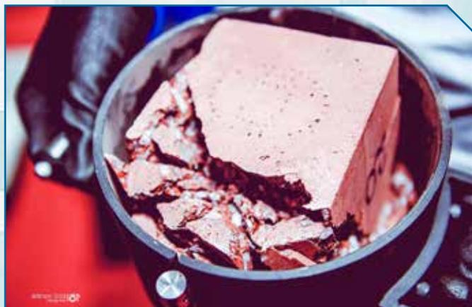
Corpo de prova após o ensaio de resistência à compressão
