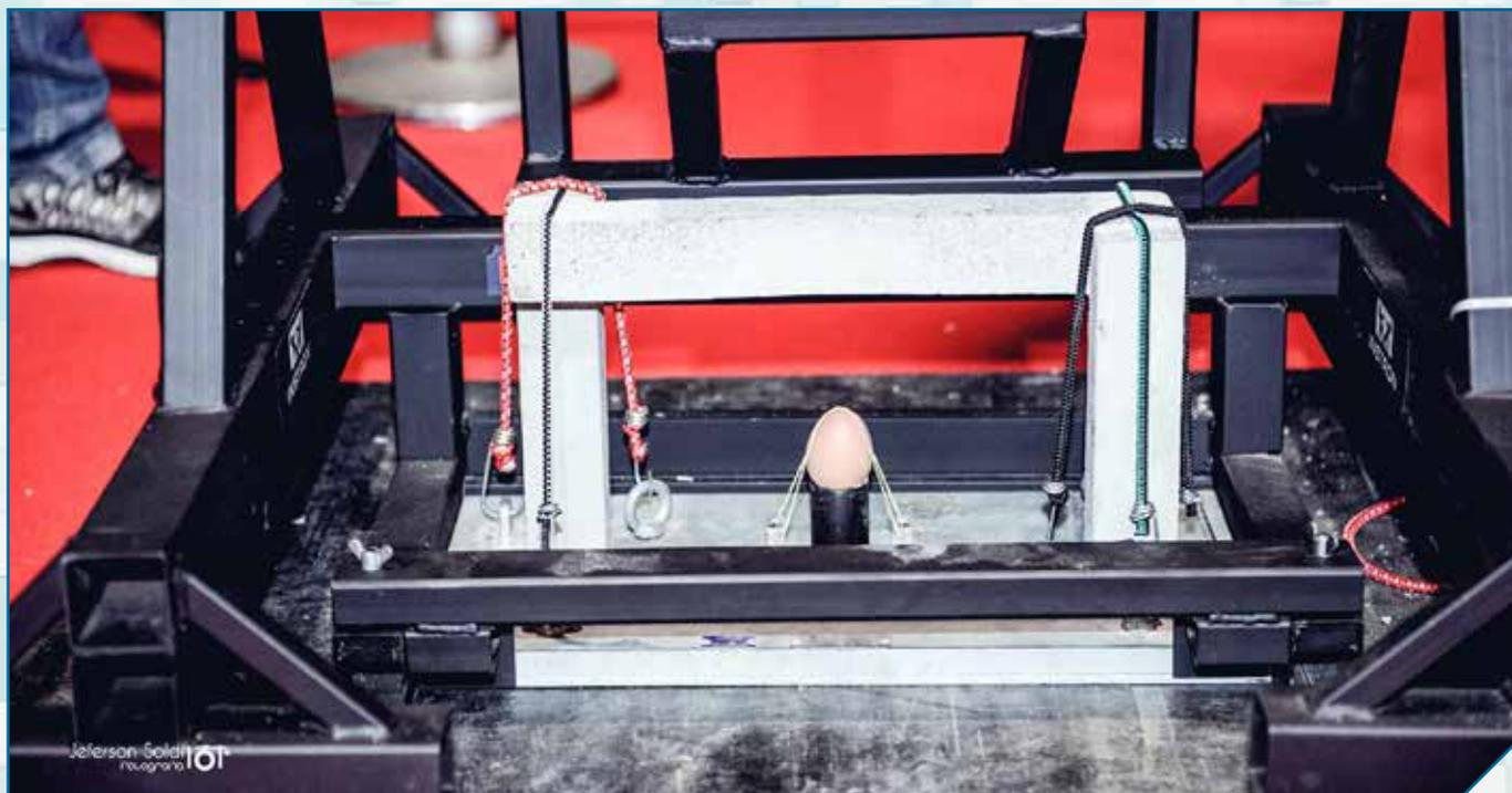
APO posicionado para o ensaio de carregamento dinâmico
