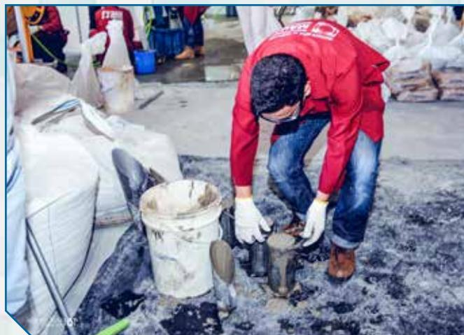
Corpos de prova preparados para o ensaio de resistência à compressão no dia seguinte
