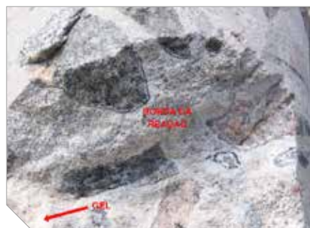
Identificação da “borda de reação” e gel de RAA por meio de ensaio laboratorial
