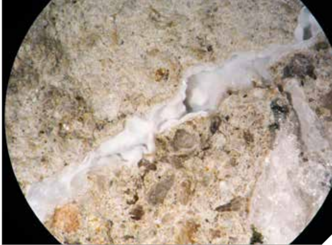
Testemunho de concreto onde se observa gel porcelânico esbranquiçado. Microscopia estereoscópica. Aumento 12x
