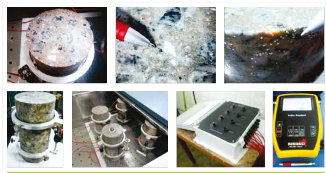
► Figura 9 Aspectos durante a realização dos ensaios, mostrando os anéis para a medida das deformações, a exsudação de gel da RAA, o tanque de cura, o terminal de leitura e a caixa de leitura
