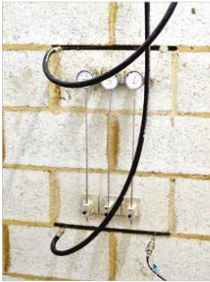
► Figura 7 Esquema do teste de macacos planos aplicado nas amostras de alvenaria
