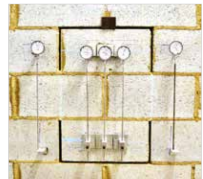
► Figura 6 Indicação da posição dos macacos e dos pontos de leitura de deformação
