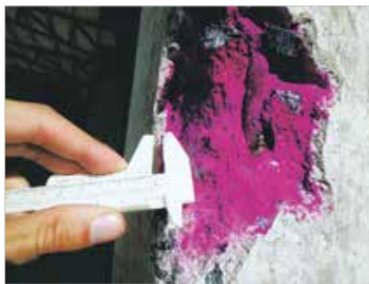
► Figura 3 Medição da profundidade de carbonatação em pilar de fachada
