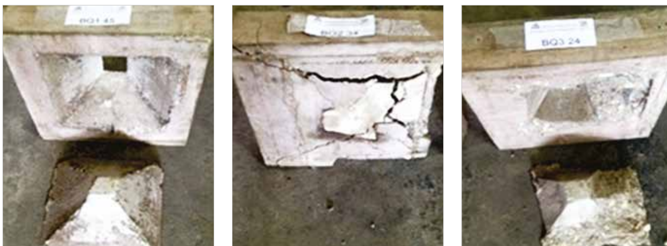
► Figura 9 Blocos da série I após os ensaios (BQ1 45, BQ2 34, BQ3 24)
