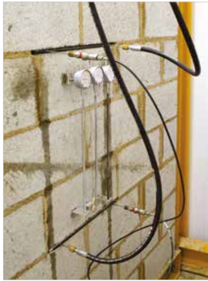
► Figura 7 Esquema do teste de macacos planos aplicado nas amostras de alvenaria
