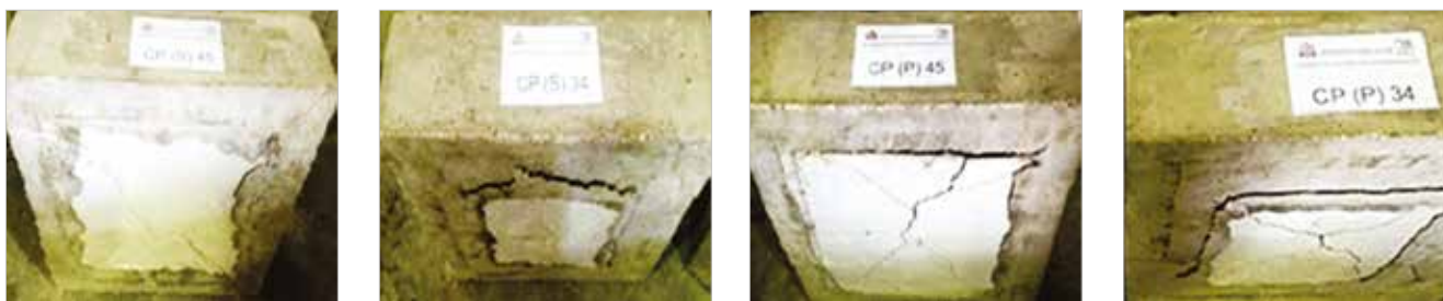
► Figura 10 Blocos da série II – CP (S) com resina epóxi; CP (P) com pinos de aço
