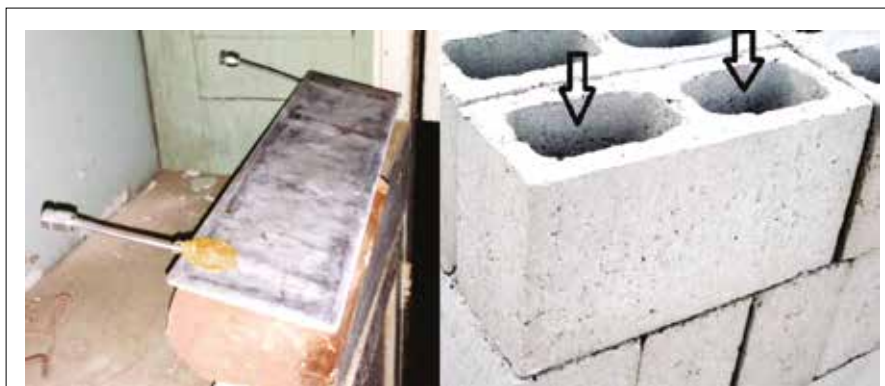
► Figura 2 Indicação do macaco plano tradicional e das áreas vazadas do bloco de concreto
