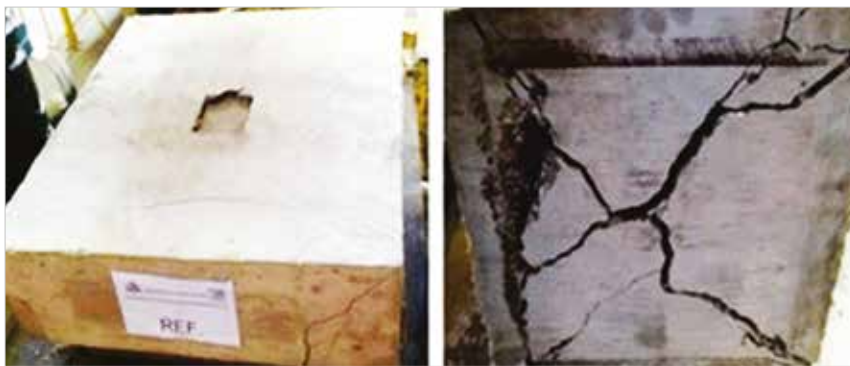
► Figura 8 Bloco de referência (monolítico) após os ensaios
