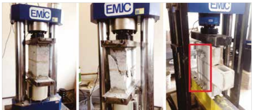
► Figura 4 Teste em prensa nos prismas e em amostras retiradas das paredes
