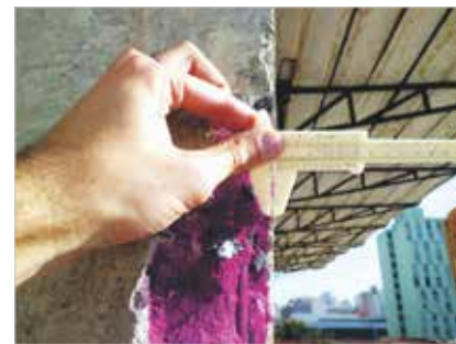
► Figura 3 Medição da profundidade de carbonatação em pilar de fachada
