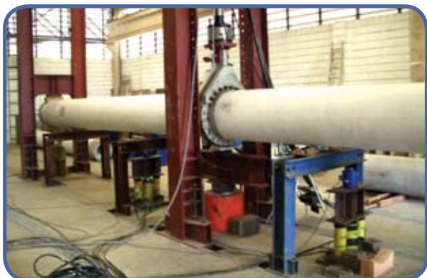
Figura 11 – Esquema de ensaio realizado (módulos sem reforço)
