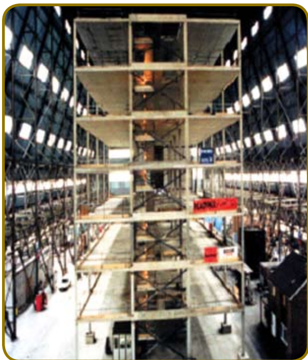
Figura 2 – Vista da estrutura da Edificação de Concreto nos laboratórios da BRE
