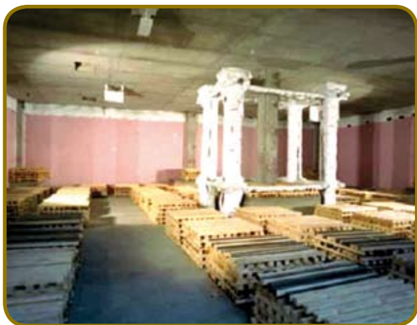
Figura 5 – Compartimento do fogo antes da Ignição. Notar pilares do 80MPa no centro e carga térmica distribuída pelo espaço
