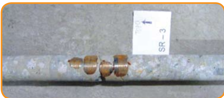
Figura 7 – Testemunho da base da sapata
