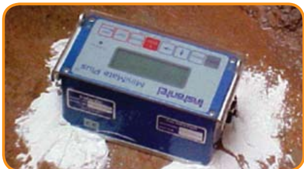
Foto 9 – Sismógrafo com registrador contínuo utilizado pelo IPT
