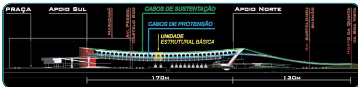
Fig. 02 – Esquema Estrutural Geral: os apoios, os cabos e as unidades estruturais básicas pré-moldadas
