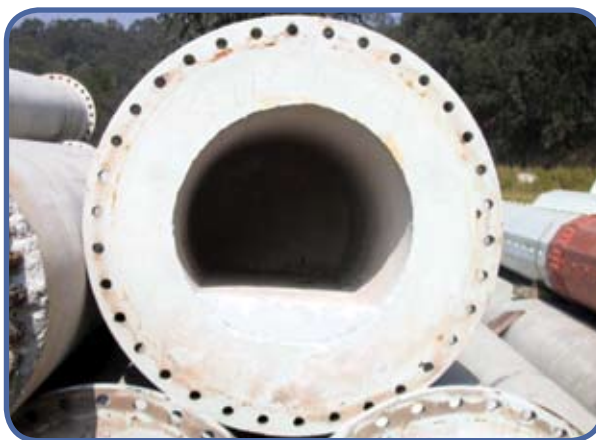
Figura 2 – Flange metálica de união entre os módulos.
