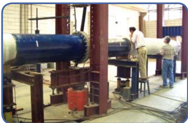
Figura 12 – Esquema do ensaio realizado (módulos reforçados)
