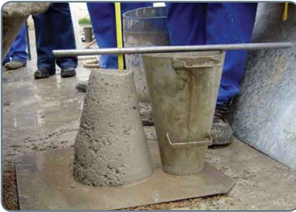
Figura 1 – Consistência antes do superplastificante.
