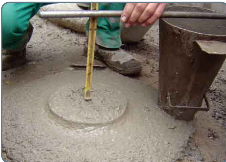
Figura 2 – Consistência 200 \pm 30 mm para projeção.
