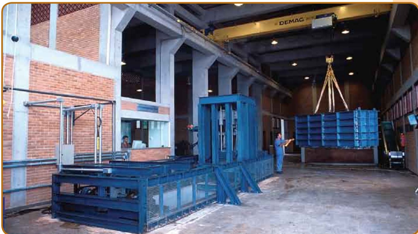
Figura 1 – Laboratório de Concreto Compactado com Rolo de FURNAS – Vista do equipamento e pista em verdadeira grandeza (FURNAS, 2002).
