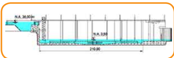
Figura 13 – Corte Longitudinal Esquemático da Eclusa II, onde podem ser vistos os níveis d'água e o comprimento da câmara.
