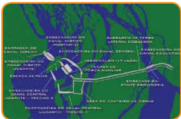
Sítio Pimental – Arranjo Geral das Obras – Vertedouro Principal e Casa de Força Auxiliar
