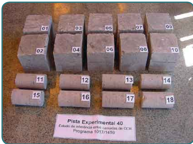
Figura 3 – Corpos-de-Prova obtidos de Testemunhos Prismáticos Juntamente com os seus Correspondentes Cilíndricos
