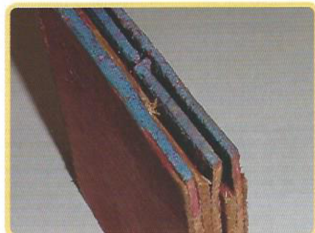
Figura 3 - Corpo de prova de chapa de madeira compensada com delaminação após ser submetido a vinte minutos de fervura.
