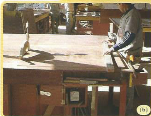
Figura 4 – (a) bancada e (b) serra circular de uma central de fôrma em canteiro de obra.
