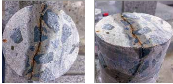
► Figura 8 Vista superior (a) e perspectiva (b) de fissura em testemunho A-10
