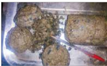
► Figura 9 Corpo de prova extraído de placa cujo concreto teve emprego excessivo de aditivo acelerador de pega. Observar material desagregando e frágil
