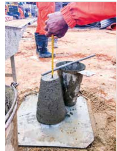
► Figura 2 Conferindo a consistência inicial ( slump ) do concreto fresco recebido na obra
