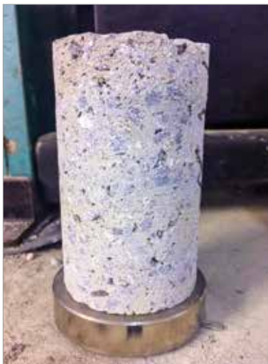
► Figura 8 Corpo de prova extraído de placa com aspecto característico
