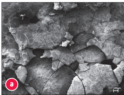
a Gel maciço/gretado observado em testemunho de concreto alterado procedente de vertedouro de UHE
