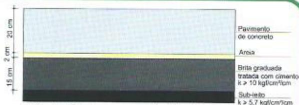
Fig. 2 - Seção transversal típica do pavimento
