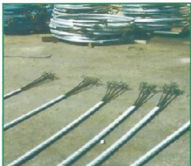
Foto 3: pré-montagem de cabos aderentes
