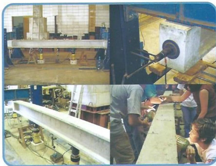
Figura 1 – Trabalho prático na EESC – viga de concreto armado e protendido – SET-411
