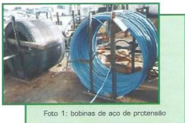
Foto 1: bobinas de aço de protensão
