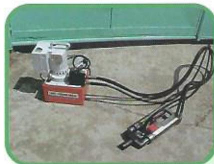
Fig. 5: Equipamentos usados para protensão
