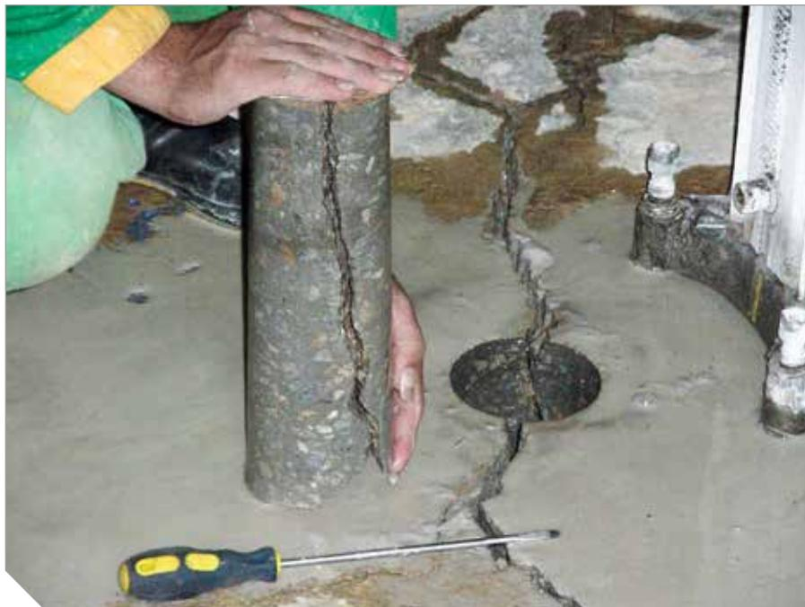
**Detalhe do testemunho extraído de fundação com fissuras**
