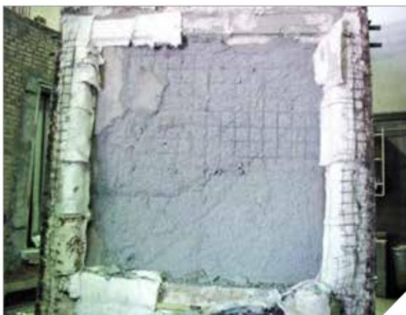
Fotos 14 e 15 – Colapso de parede estrutural em decorrência do lascamento explosivo
