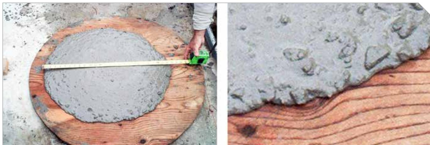
Foto 4 – *Slump-flow* de concreto autoadensável com detalhe da borda sem exsudação
