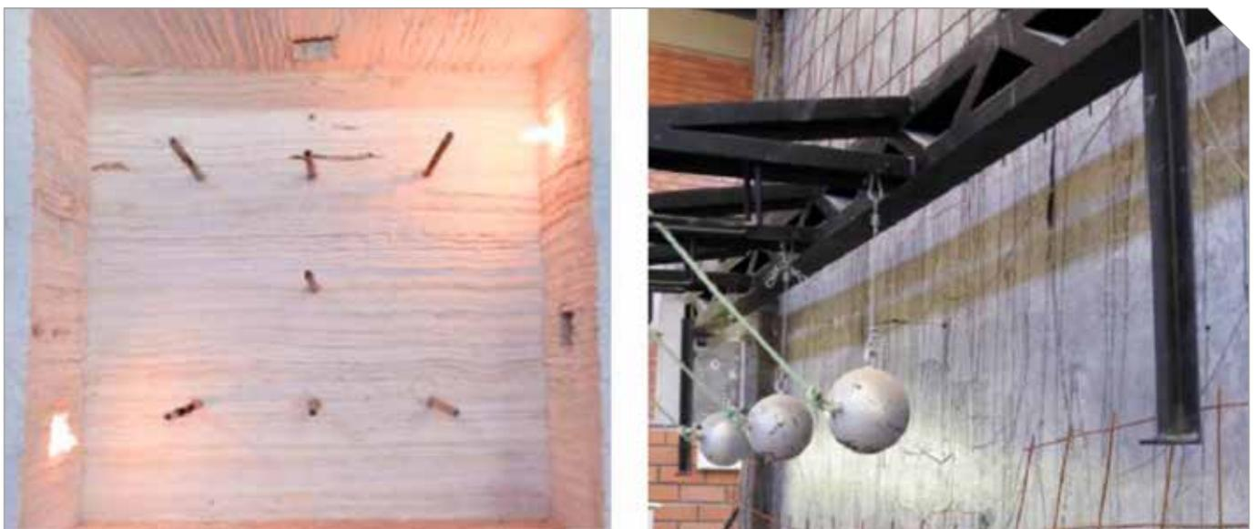
Foto 5 – Detalhe dos termopares para ensaio de incêndio e execução do ensaio de percussão na parede
