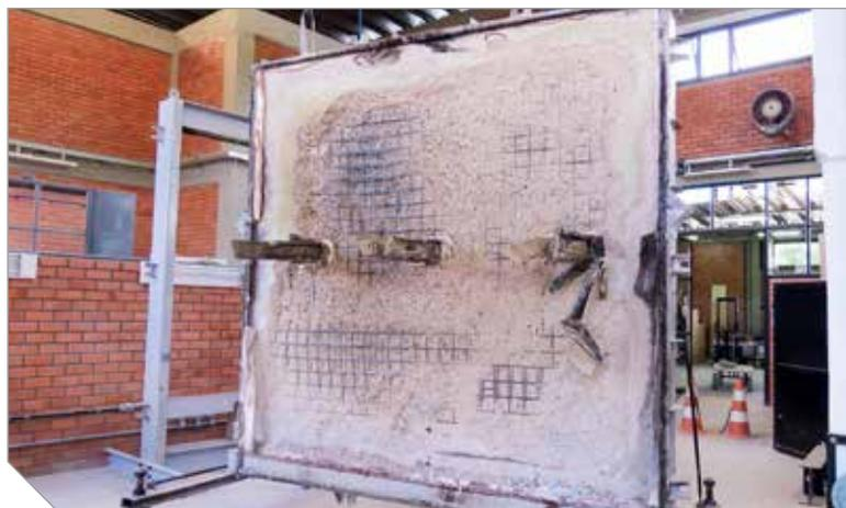
**Parede de concreto armado com instalação de sistemas de barramentos após ensaio de resistência ao fogo no itt Performance/Unisinos**
