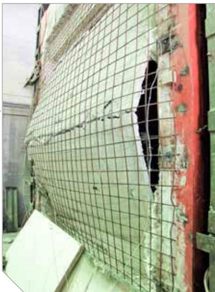
**Colapso de parede de concreto durante o ensaio de resistência ao fogo no IPT**
