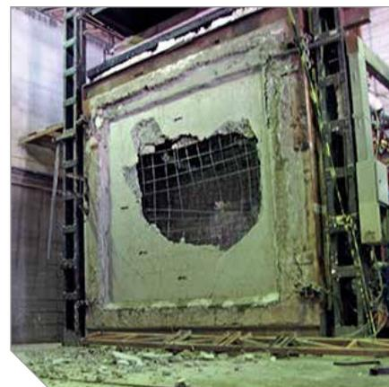
**Foto 12 – Parede de concreto com perda de integridade decorrente de um “lascamento” instantâneo**
