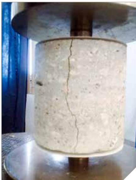
Ensaio de duplo puncionamento realizado em testemunho extraído
