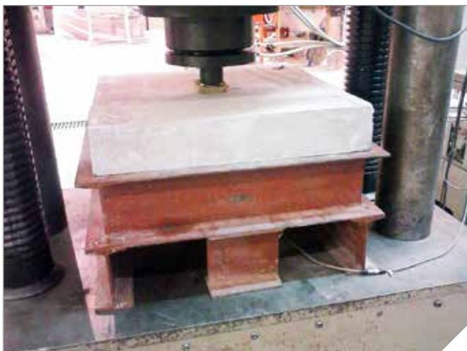
Ensaio de punção de placas (EFNARC, 1996)
