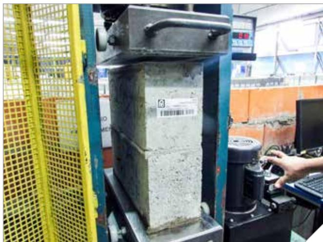
Ensaio de compressão de prisma de bloco de concreto
