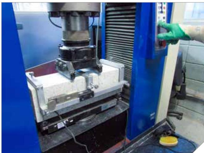
**Ensaio de determinação da Tenacidade em concreto com Fibra**
