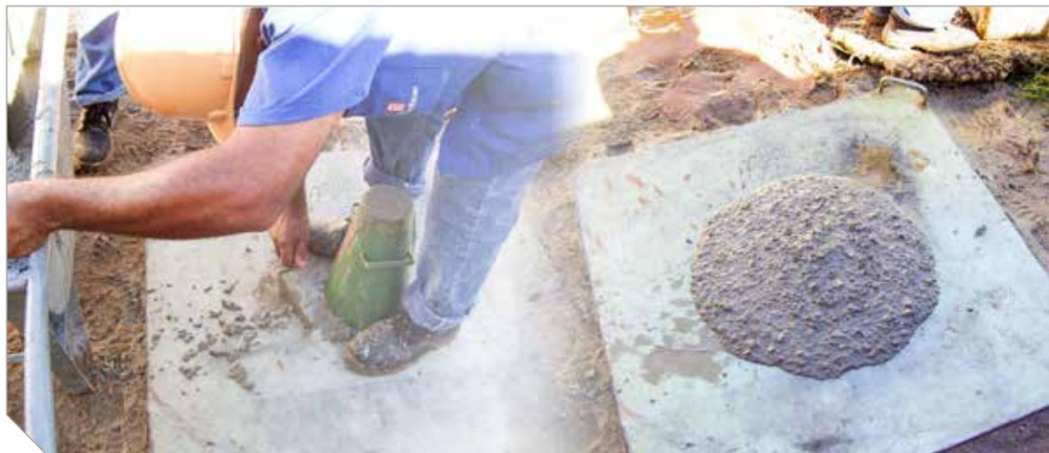
Ensaio de abatimento do concreto
