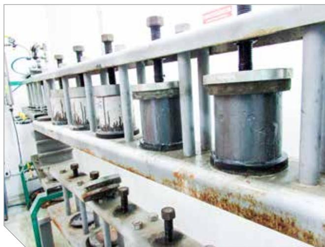
Ensaio de penetração de água em concreto
