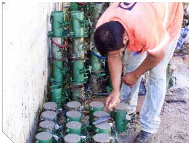
**Moldagem de corpos de prova para ensaio de resistência à compressão**
