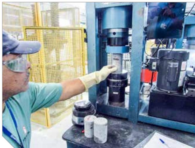
**Ensaio de compressão axial de corpo de prova de concreto extraído de estrutura**
