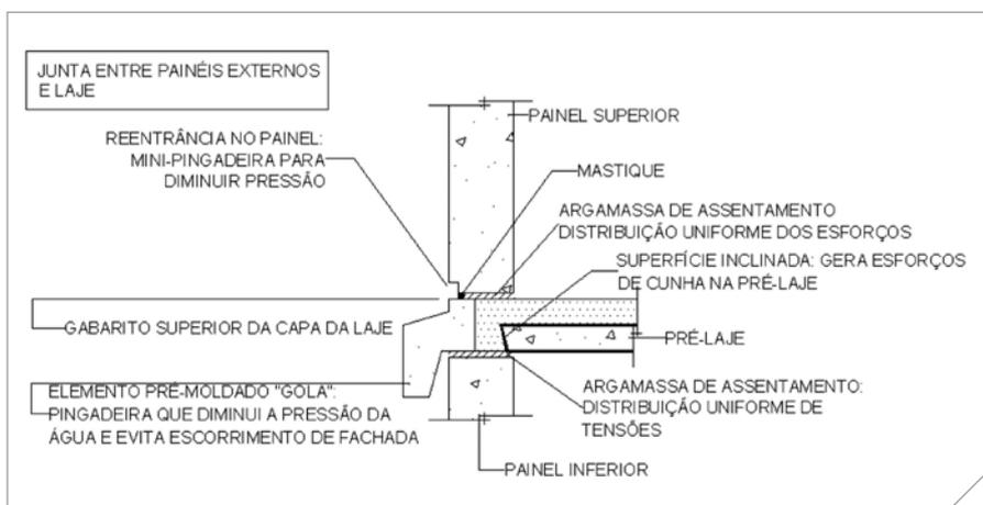
Desenho esquemático ilustrando a junta horizontal no encontro de dois painéis de andares sucessivos
