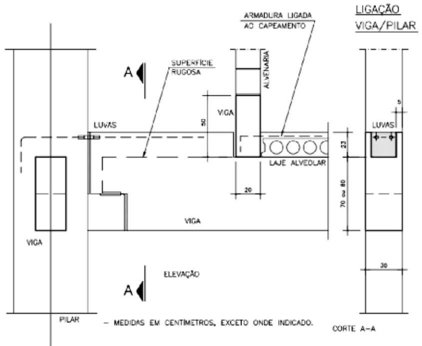
VIGAS NO LIMITE DE LAJES P/ SUPORTE DE ALVENARIAS E GUARDA CORPO
