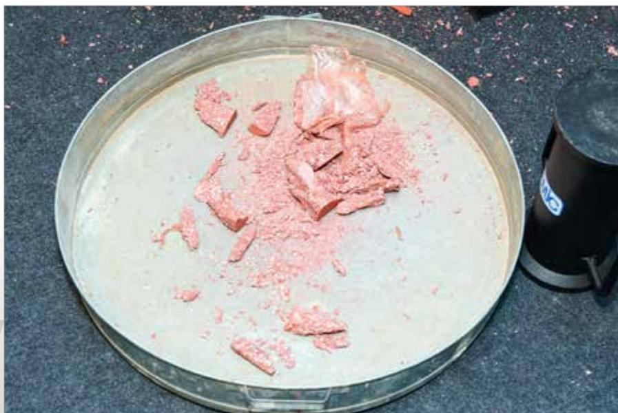
Corpo de prova despedaça-se no ensaio de resistência à compressão
