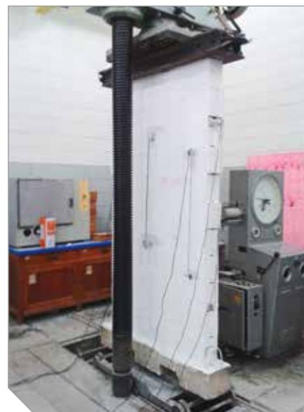
**Ensaio em parede de blocos de concreto**
