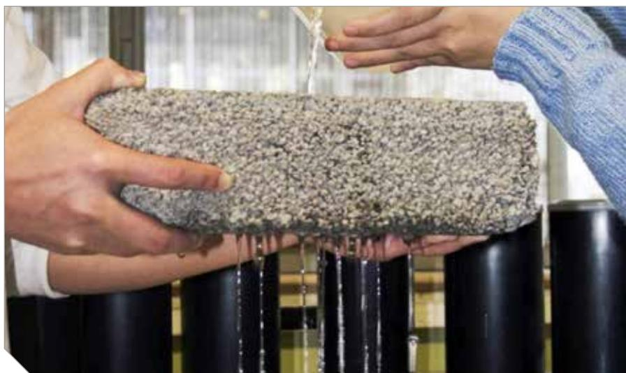
Teste de permeabilidade de bloco de concreto
