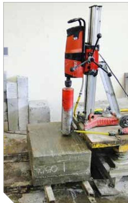
**Equipamento extrator de testemunhos de estruturas de concreto**
