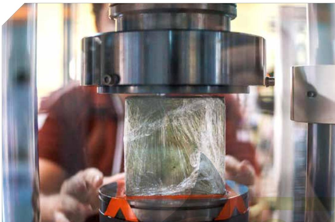
Corpo de prova cúbico em teste de compressão
