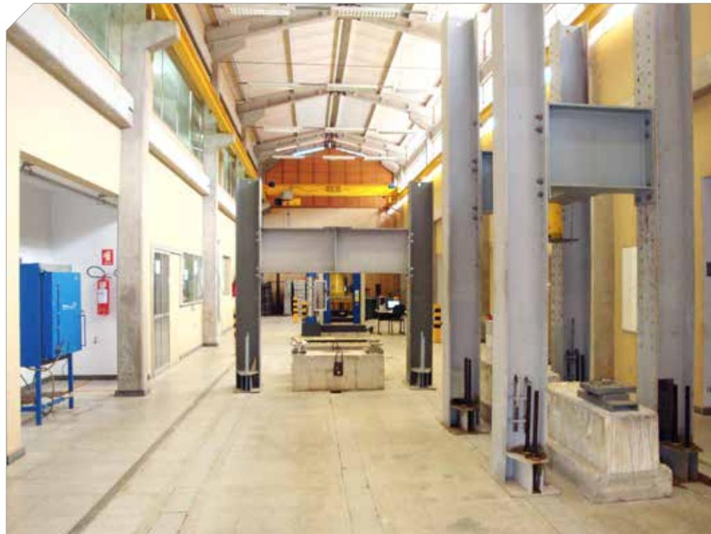
**LABITECC, construído em concreto pré-moldado, onde se observam a ponte rolante e o pórtico de reação**
