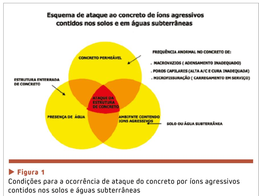
importância a análise da água e da parte solúvel dos solos em contato com a estrutura. Diversas normas internacionais e também nacional (ABNT NBR 12655:2015) estabelecem critérios para classificar o grau de agressividade da água e do solo ao concreto e a partir dessa classificação projetar para o concreto determinadas propriedades, entre elas as decorrentes da relação água/cimento e da resistência característica à compressão ( $f_{ck}$ ), com vistas a aumentar a sua durabilidade e vida útil.
