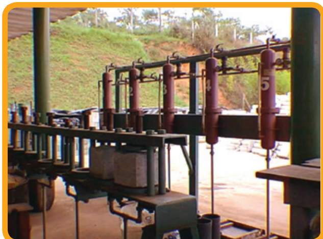
Ensaio de penetração de água sob pressão em corpos de prova em concreto projetado
