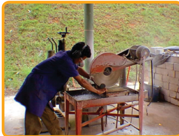
Preparação do topo de corpo de prova extraído do concreto projetado
