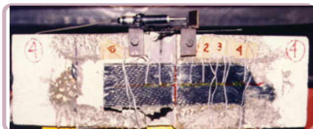
Figura 14 - Aspecto da ruptura de P4.
