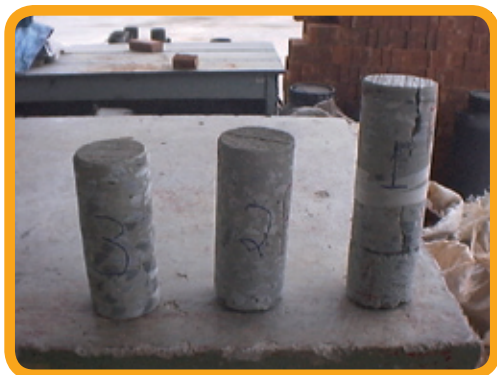
Testemunhos de perfuração em solo e rocha
