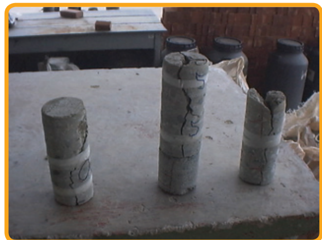
Testemunhos de perfuração em solo e rocha
