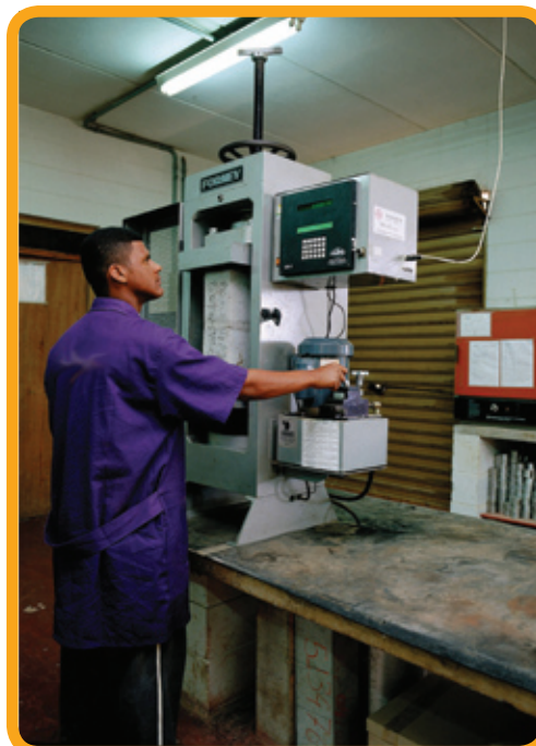
Ensaio de resistência a compressão em blocos de concreto
