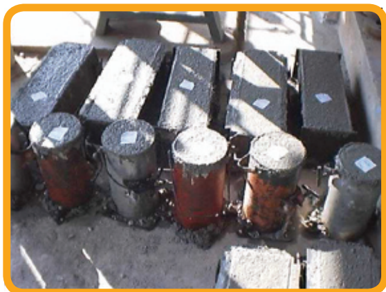
Corpos de prova cilíndricos e prismáticos de concreto reforçado com fibras.
