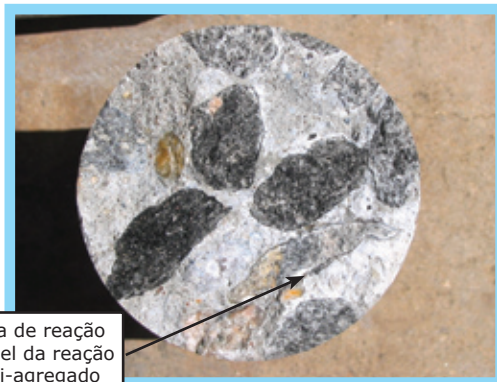
Figura 4 - Detalhe de concreto extraído de um dos blocos de fundação. Nota-se o gel da reação álcali-agregado em torno dos agregados graúdos.
