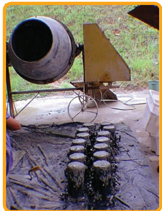
Moldagem de corpos de prova 15x30 cm em concreto
