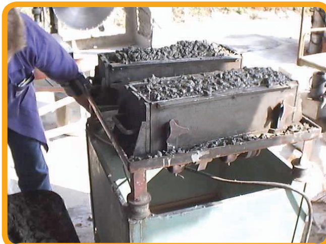
Moldagem de corpos de prova prismáticos com concreto reforçado com fibras em mesa vibratória.
