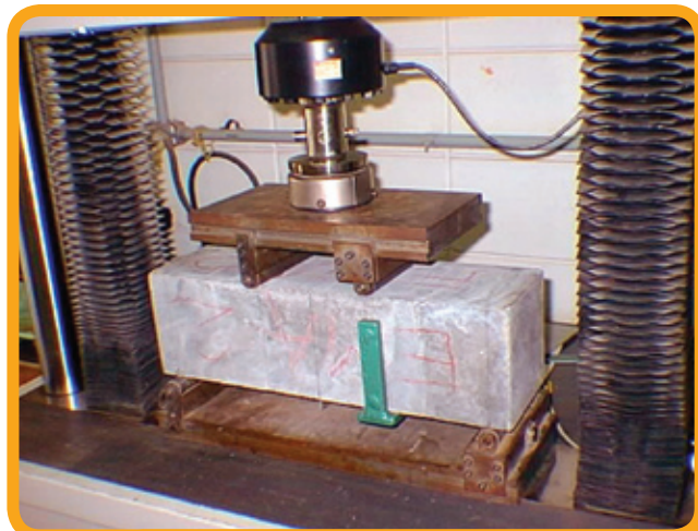
Ensaio para determinação da tenacidade em prisma de concreto reforçado com fibras
