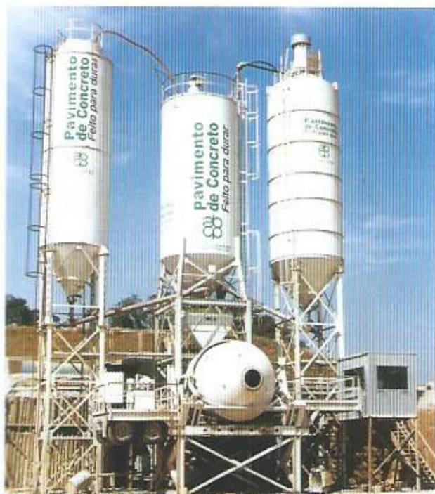
FIGURA 12- USINA DOSADORA E MISTURADORA, TRANSPORTÁVEL
