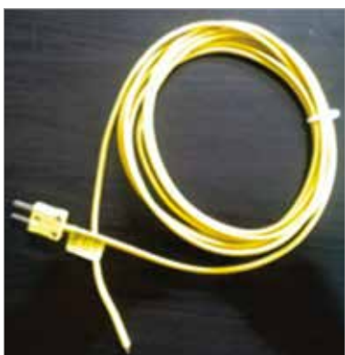
► Figura 14 Termopar para monitoramento da temperatura dentro do bloco de fundação
