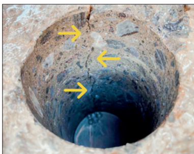
► Figura 10 Detalhe interno do furo de extração e da fissura na superfície do bloco, observada em campo
