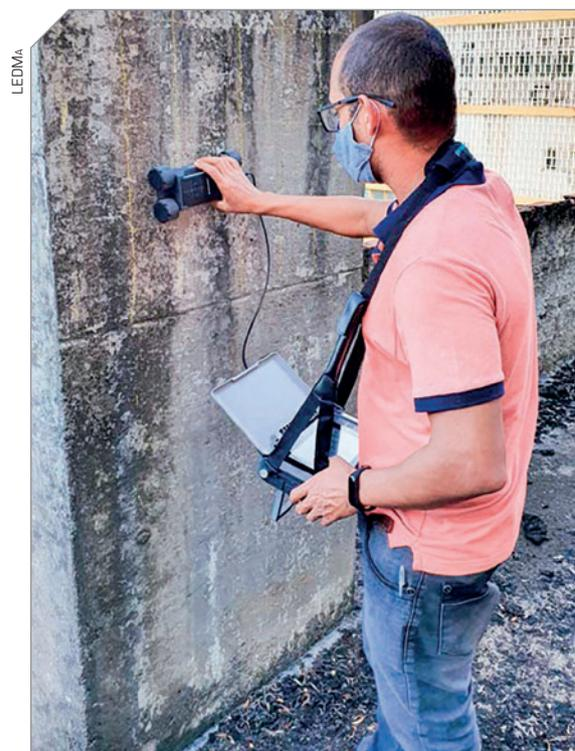
Identificação das armaduras para ensaio de potencial de corrosão
