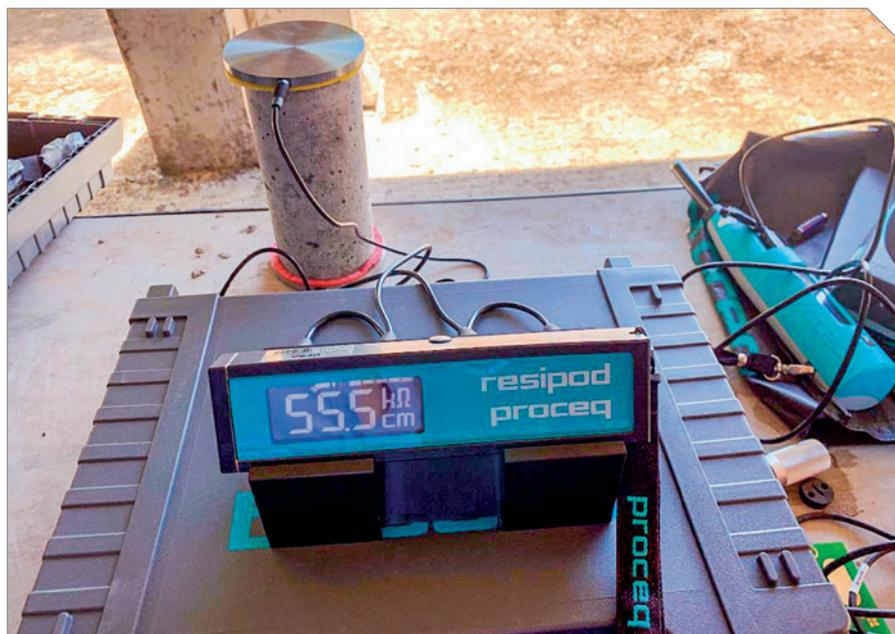
Medida de Resistividade Elétrica Volumétrica do concreto
